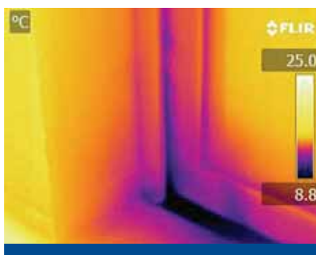
Primer uporabe IR-tehnologije med testom blowerdoor
