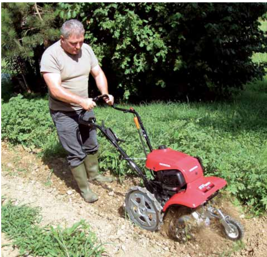
Rezila tudi zbito zemljo s postopno obdelavo spremenijo v gredico.
