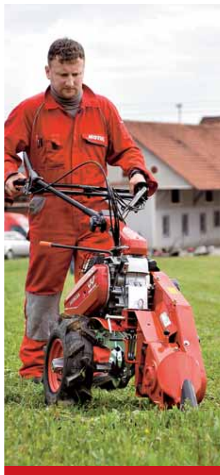
Z dodatnimi priključki lahko motokultivator spremenimo tudi v kosilnico.
